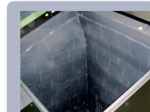
Optional ist der HDG Euro mit einer im Füllschacht eingeschweißten feuerbeständigen Spezialausklei- dung für das dauerhafte Zuheizen von Hackschnitzeln, Spänebriketts und Schreineriabfällen gemäß Brennstoffklasse 6 und 7 (gemäß 1. BImSchV für holzbe- und ver- arbeitende Betriebe) erhältlich. Die Füllschachtbreite reduziert sich bei dieser Variante auf ca. 54 cm, das Füllschacht- volumen verringert sich mit der notwendigen Rostanhebung auf ca. 200 l.
